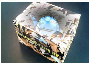
Figure 15: Captura de pantalla de una aplicación desarrollada usando Qualcomm AR SDK -Vuforia. La tetera azul (objeto virtual) se encuentra parcialmente ocluida por la caja real que sirve como marcador ( https://ar.qualcomm.at/qdevnet/developer_guide ).
